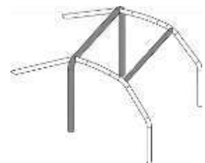
1 arco principal 2 barras laterais dos meios aros 1 membro transversal 2 apoios traseiros (backstays)
